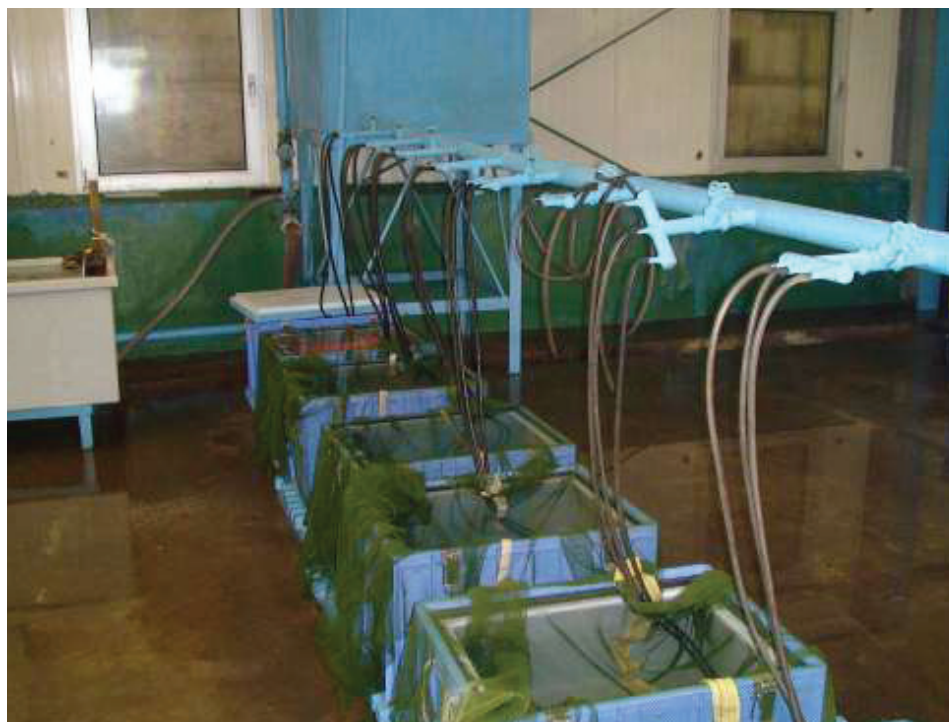
Рис. 14. Участок оплодотворительного цеха, где происходит набухание икры в транспортировочных контейнерах, забойка Курильского ЛРЗ [7]
